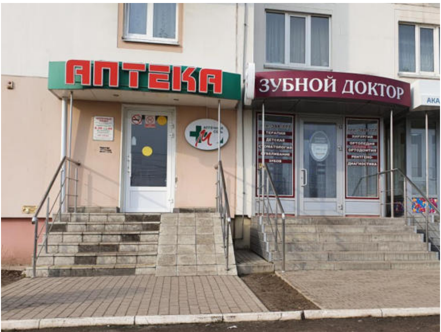
❌ Пандус для МГН имеет ненормативный уклон, а кнопка помощи находится в недоступном месте. Плитка для отделки ступеней является неэстетичной
