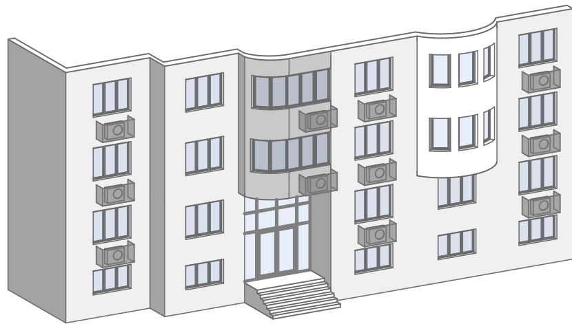
Варианты правильного размещения наружных блоков кондиционеров
