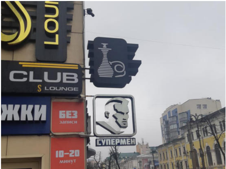
Использование фигурных панелей-кронштейнов индивидуального дизайна Размещение более чем в один уровень. Расстояние от земли до нижнего края консольной конструкции менее 2,5м
