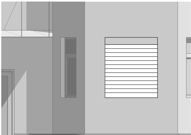
Защитный экран имеет скрытый короб
